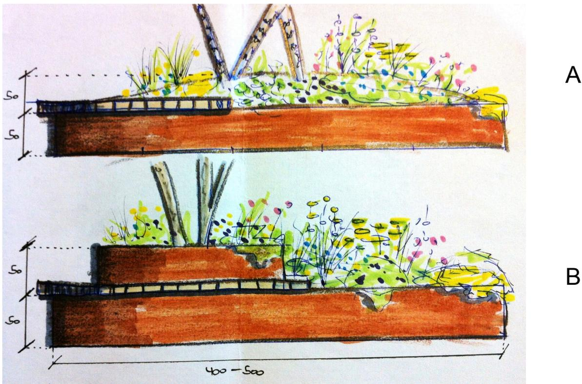
Abbildung 13: Varianten der Bauminseln. A mit gehäuftem Substrat. B mit zusätzlichem Stahlrahmen für mehr Wurzelraum. Eine exzentrische Pflanzung der Gehölze schafft mehr Spannung. Skizze: Buehrle
