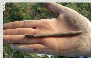
Bild 5: Bleistiftprobe zur Bestimmung der Bodenbeschaffenheit
