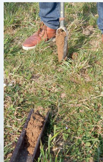
Bild 2: Bohrung des Bodenprofils
