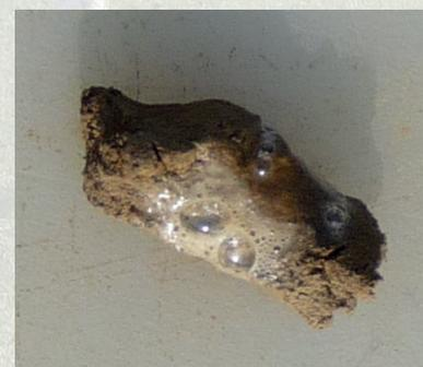
Bild 4: Salzsäuretest beim BC Horizont
